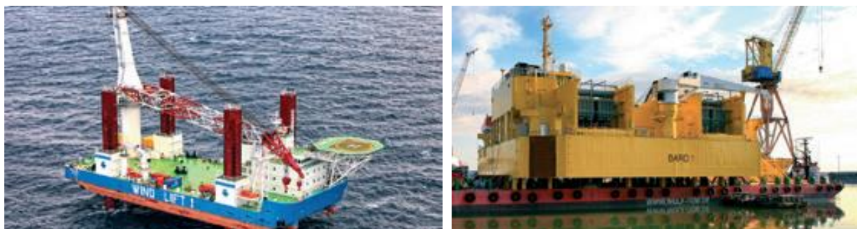
6.7.2.5 pav. Vėjo jėginių montavimo laivas „Windlift I“ ir transformatorių platforma.
