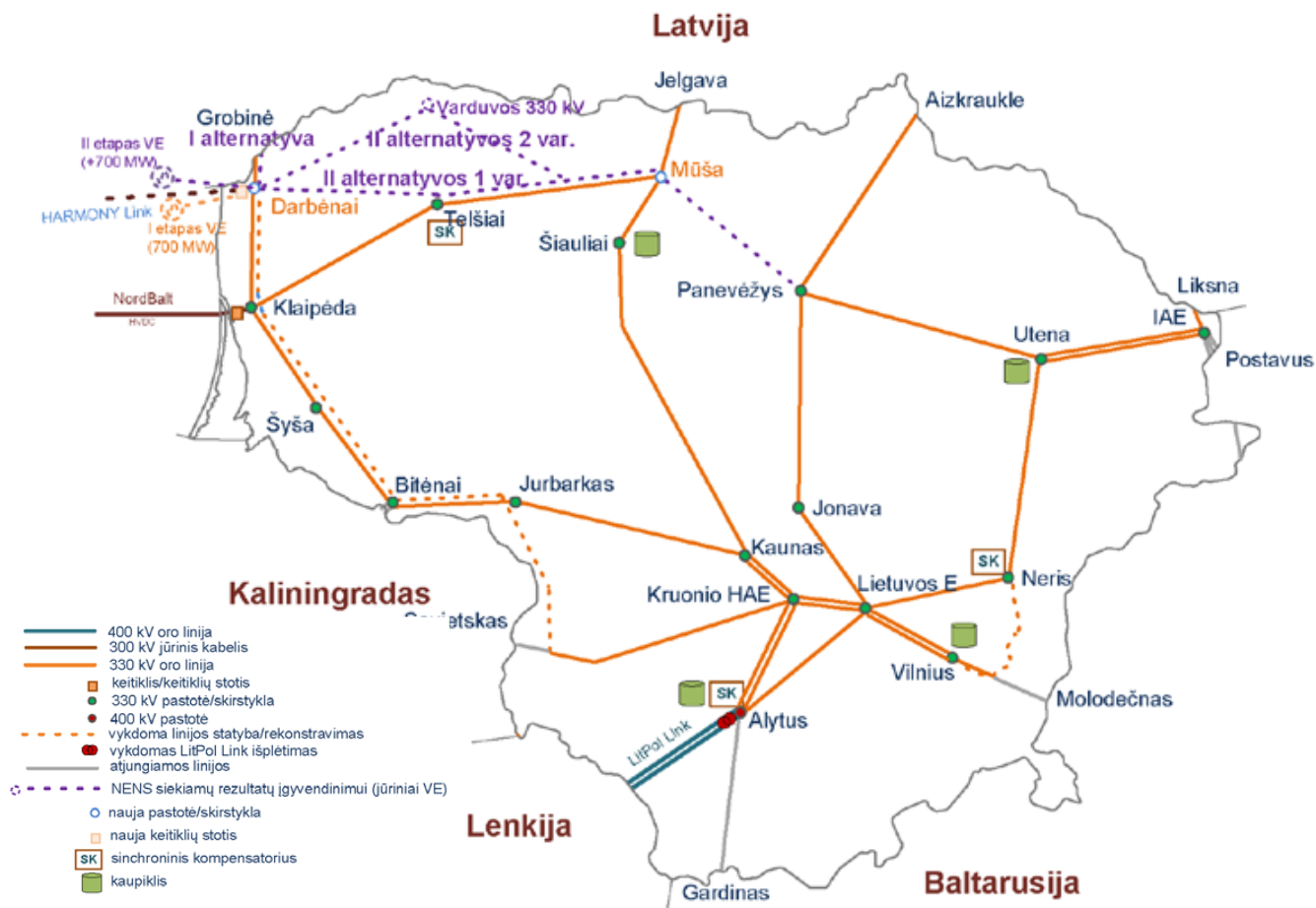
6.7.3.1 pav. 400-330 kV perdavimo tinklas 2030 m., kai Lietuvos EES sinchroniškai dirba su KET ir Baltijos jūroje įrengti jūriniai VE parkai.
