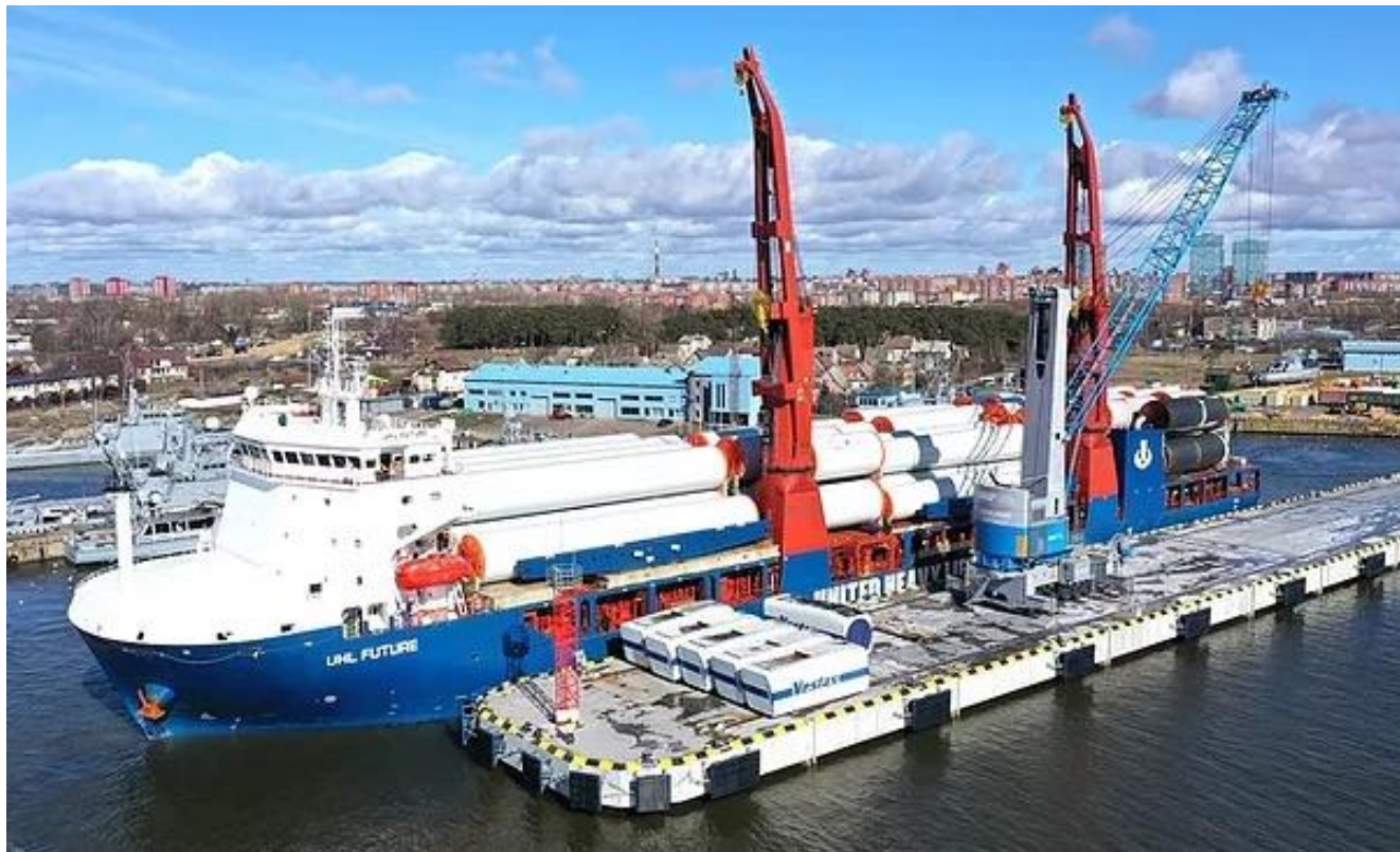
6.7.2.4 pav. Laivas „UHL Future“ su 6900 t vėjo jėginių komponentų kroviniu iškraunamas KKT.
