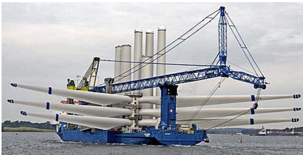
1.2.7 pav. Laivas „Sea Power“ gabena vėjo turbinas į Lillgrund VE parko statybos vietą (nuotrauka iš Jeppsson et al. 2008).
