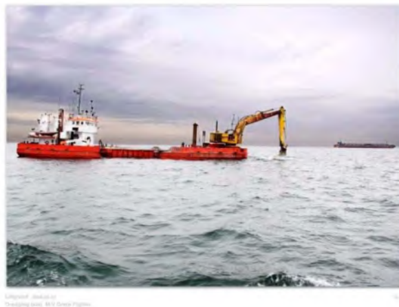
1.2.2 pav. VE pamatų įrengimas: dugno darbai (nuotrauka iš Jeppsson et al. 2008).
